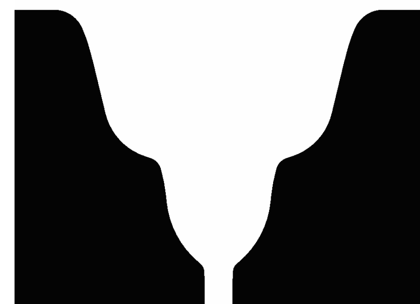
Figura 1. Geometría propuesta para enfocador compuesto de alto Re y amplio rango.
